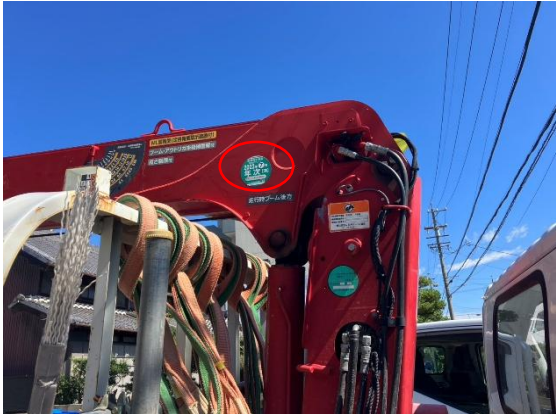
クレーン年次点検実施済み。
