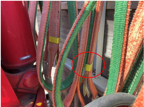
スリングの点検実施済み。
